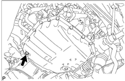
c. Используя торцевую шестигранную головку 6 мм, убедитесь, что патрубок маслоналивной горловины трансмиссии № 1 затянут с номинальным моментом затяжки.
