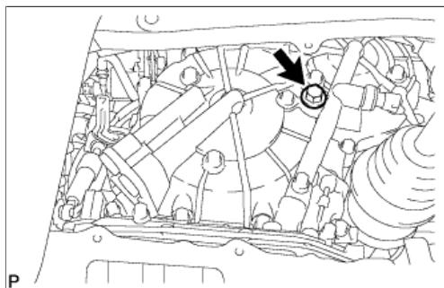
b. С помощью торцевой шестигранной головки 6 мм снимите пробку переливного отверстия и прокладку с бесступенчатой трансмиссией.
