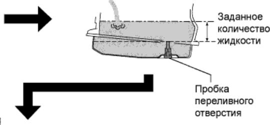
**3. ОТРЕГУЛИРУЙТЕ ТЕМПЕРАТУРУ ЖИДКОСТИ**
