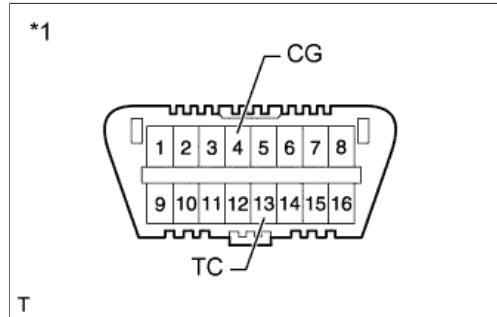
i. С помощью SST соедините контакты 13 (TC) и 4 (CG) разъема DLC3 при выключенном зажигании.
